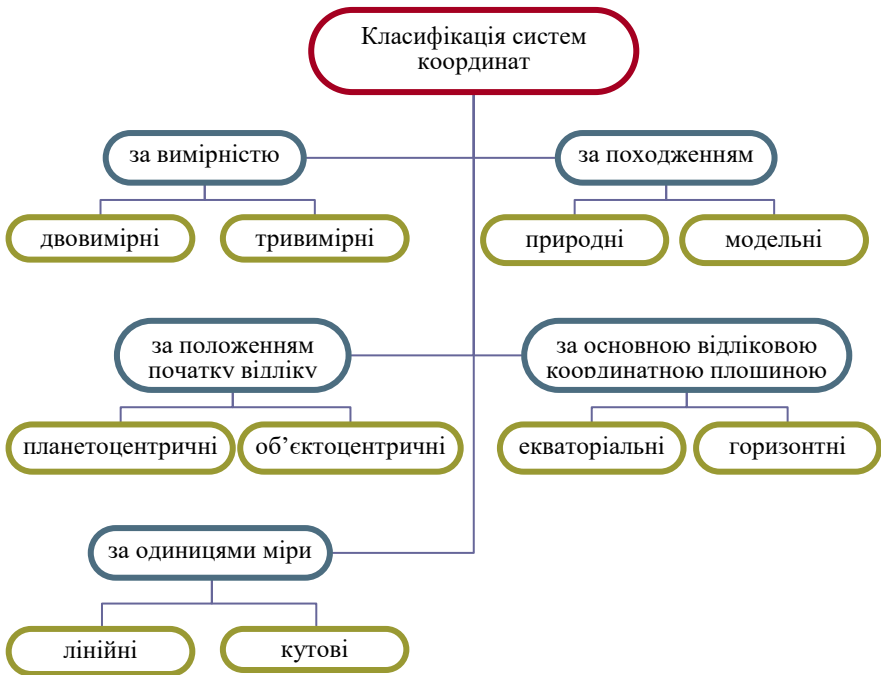
Рис. 1. Класифікація систем координат, які використовуються в геодезії
