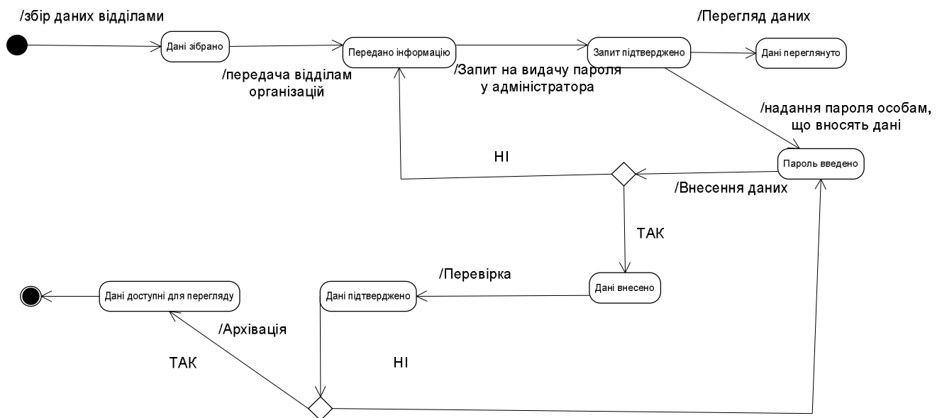
Рисунок 2.2 – Діаграма станів внесення інформації у базу даних
