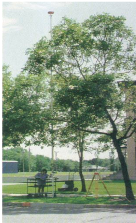
Рисунок 2.2 – Використання телескопічної віхи для встановлення GPS-антени на висоту 10,5 метрів [25]
