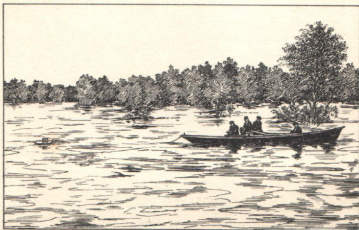
Наблюденія надъ скоростями теченія въ поймѣ при помощи вертушки—лага.
