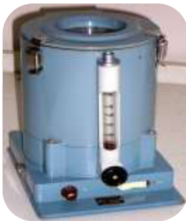
Рис. 7. 3 Апарат кротова; 1 – клиноподібна щілина; 2 – диск, що обертається; 3 – реометр
