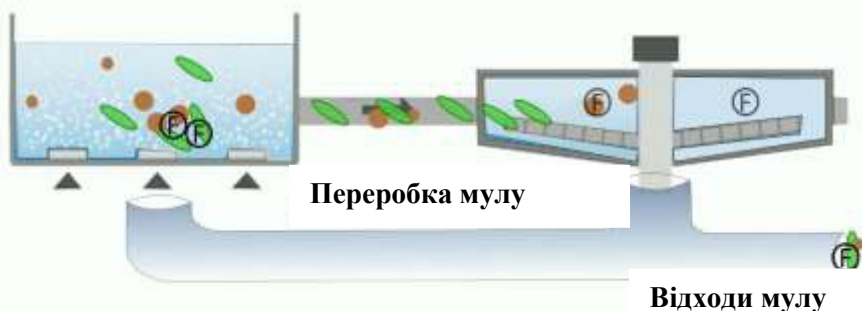
Рис 5. 3 Схема очистки стічних вод в аеротенках
