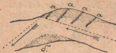
Рис. 30. Поперечные полузапруды.
