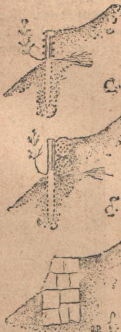
Рис. 34. Прерывающіяся запруды въ поперечномъ разрѣзѣ: а—изъ переплетенныхъ колосьевъ, б—изъ фашинника, в—изъ камня.
