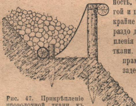
Рис. 47. Прикрѣпленіе проволочной ткани къ вбитымъ въ землю сваямъ
