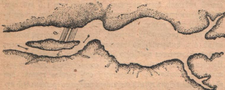
Рис. 56. Запруженный оврагъ (въ планѣ): а — плотина, б — естественный водообходъ.
