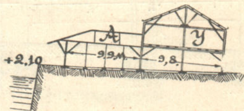
Рис. 90. Устройство склада для соленой рыбы.
