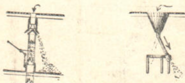
Рис. 82. Устройство для направления зерна из норки в различные силосы.
