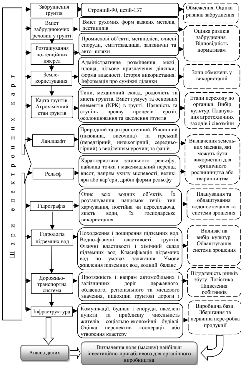
Рис. 3.6. Алгоритм накладання шарів електронних карт
