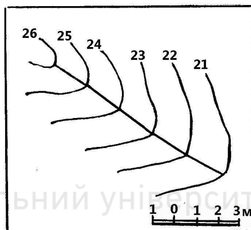
Рис. 5.24. Позначення на плані земної поверхні лінії водорозділу
