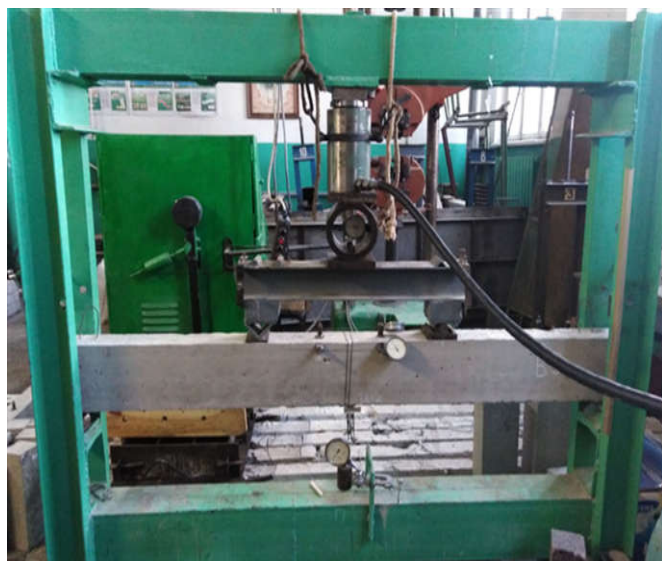
Рисунок 17 – Вигляд дослідної установки з балкою Б-3
