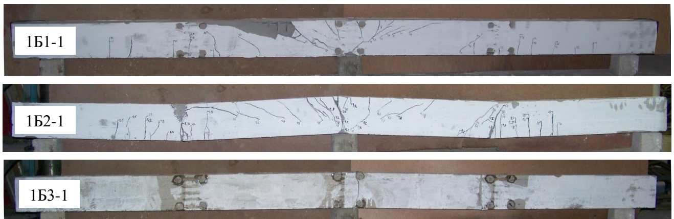
Рисунок 5 – Характер руйнування балок першої серії
