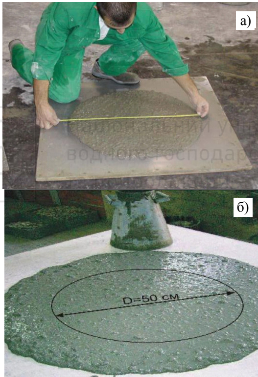
Рис. 5.1. Визначення розпливу конуса (Slump flow) – (а) та часу розпливу (slump flow time T_{500} ) (б)
