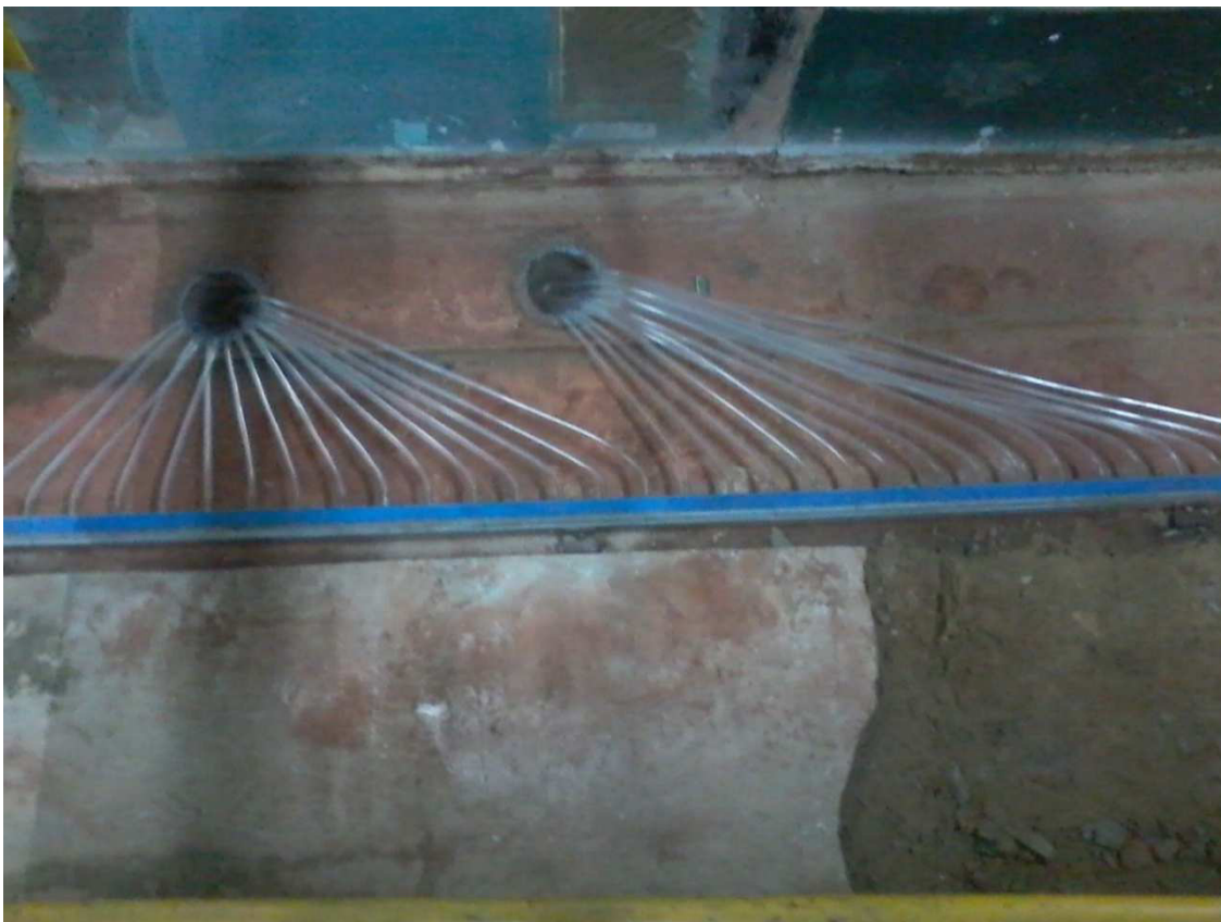
Рисунок 2.5 – Закріплення планки з приймальними отворами до дна лотка
