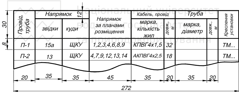
Рисунок 1.5. Розміри таблиці з'єднань зовнішніх проводок
