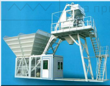
Рис. 1.1. Мобільні заводи: а- бетонний; б – асфальтний
