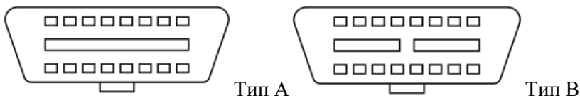
Рис. 2. Штекери OBD-2 за SAE J1962 відповідно тип А і тип В
