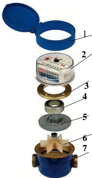
Рис. 16. Конструкція водолічильника:
