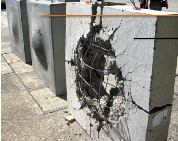
Рис. 1.1. Результат випробувань вибухом залізобетонних плит, підсилених і не підсилених за допомогою РПБ DUCON®
