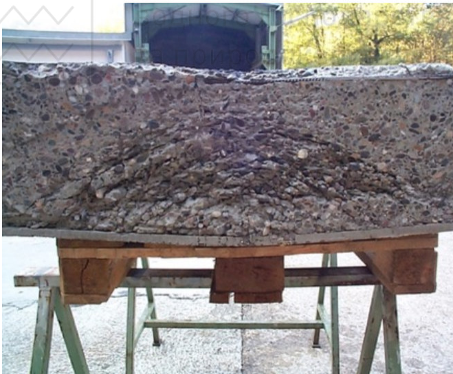
Рис. 1.3. Залізобетонна плита із захисним шаром РПБ, для захисту від утворення уламків при руйнуванні
