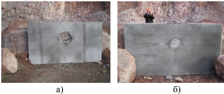
Рис. 1.2. Результати випробування залізобетонної плити (а) та плити з РПБ (б) шляхом контактної детонації
