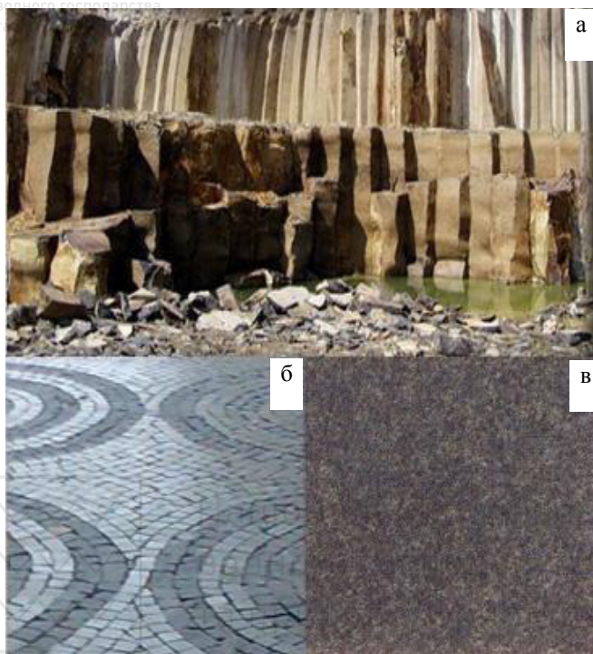
Рис.1.2. Загальний вид базальтового кар'єру (а), бруківки з базальту (б) і структури полірованої базальтової плити (в)
