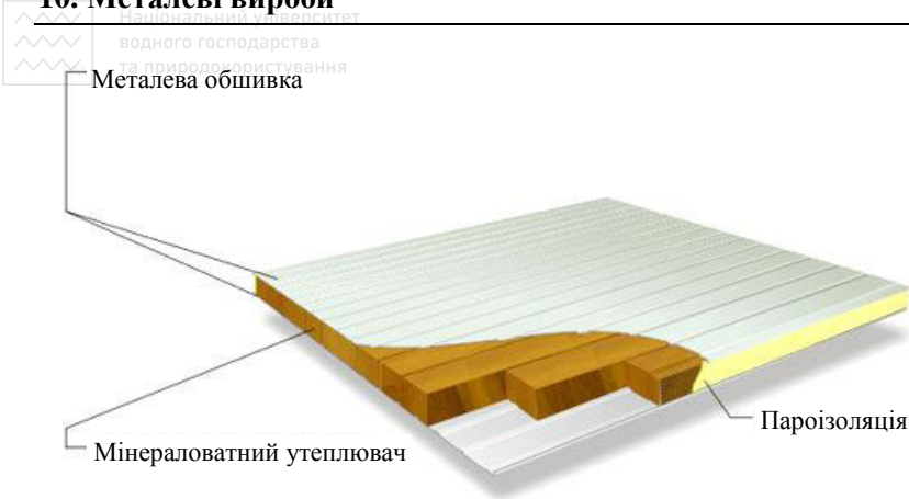
Рис. 10.3. Схема панелі з мінераловатним утеплювачем
