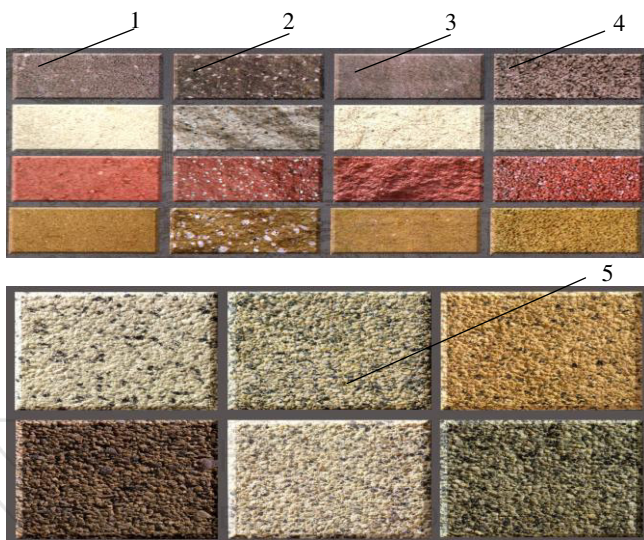
Рис. 4.5. Декоративні бетони різної фактури: 1 – гладка; 2 – колена з крупним заповнювачем; 3 – колена з дрібним заповнювачем; 4 – зерниста; 5 – мозаїчні фактури, отримані способом розмивання шару в'язучого
