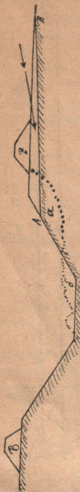
Рис. 2. В—валик, АВ—дно воронки, а—промыль откоса у устья воронки; б—засорения дна канавы. (Стрелкой показано направление стока воды в канаву через воронку).
