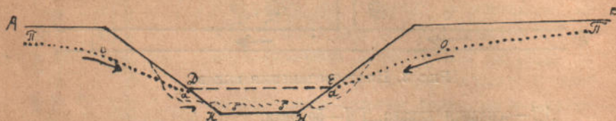
Рис. 5. Д Е—уровень воды в канаве, А О П—линия понижения воды в почве, а а разрушение откосов, б б засорение дна.
