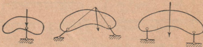
Рис. 40. Устройство опор, не гарантирующее неподвижности сооружения: один или два стержня.
