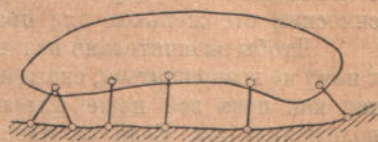
Рис. 42. Статически-неопределимый случай; два крайних левых стержня и один крайний правый могут быть приняты за классические.
