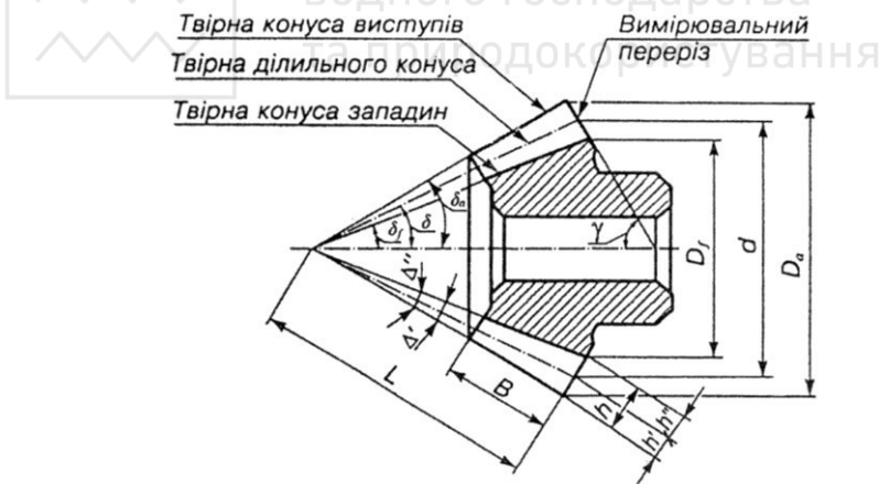
Рис. 1.5. Конічне зубчасте колесо
