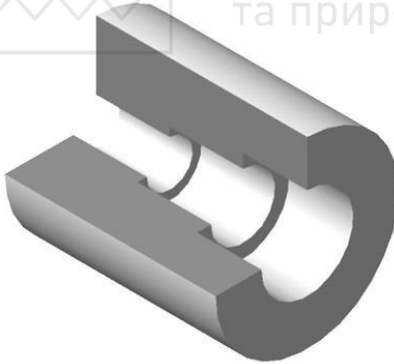
Рис. 1.35. Вибір головного виду для деталі, яка обмежена ступінчастими циліндричними поверхнями
