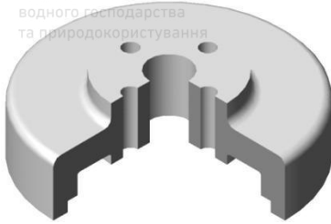
Рис. 1.36. Поєднання виду із розрізом
