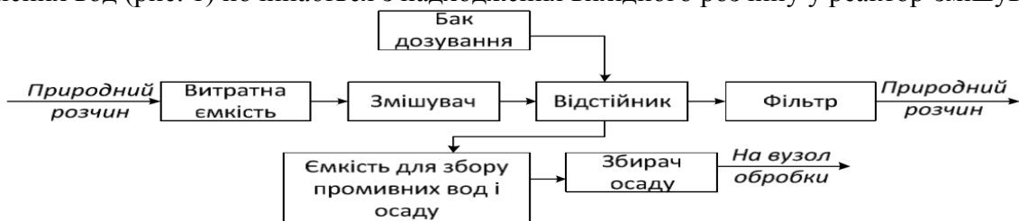
Рис. 1. Технологічна схема попереднього очищення літійвмісних вод
