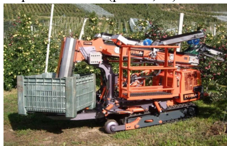
Рис. 2. Самохідна платформа для збирання фруктів Revo Puima Revolution Pianura (Італія)
