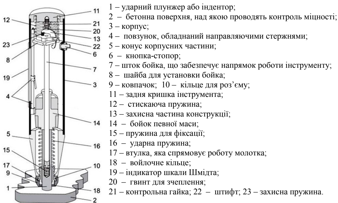
Рис. 1. Конструкція склерометра Шмідта
