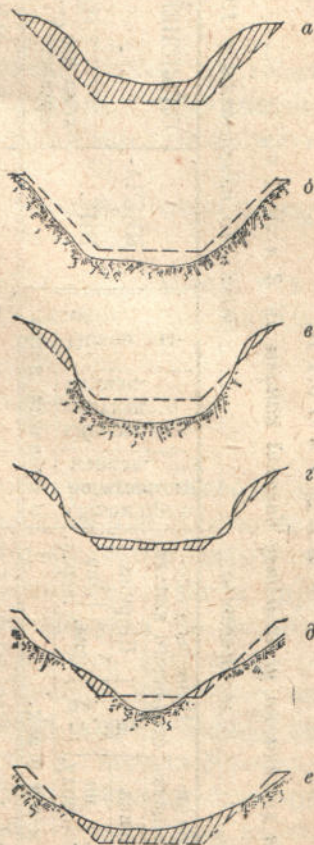
Сплошным—существующий профиль. Пунктиром—проектируемый профиль. Заштриховано—выемка.
