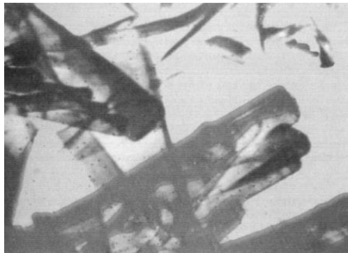
Рис.2.9. Утворення кристалів еtringіту в цементній системі, що гідратується
