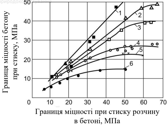
Рис.3.21. Залежність міцності при стиску керамзитобетону від густини заповнювачів і міцності розчинової частини бетону:
