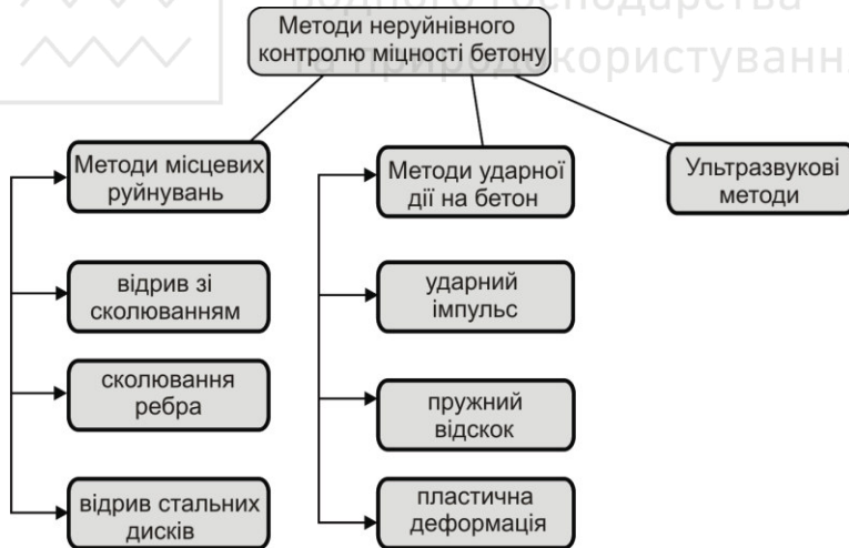
Рис. 6.9. Класифікація методів неруйнівного контролю міцності бетону
