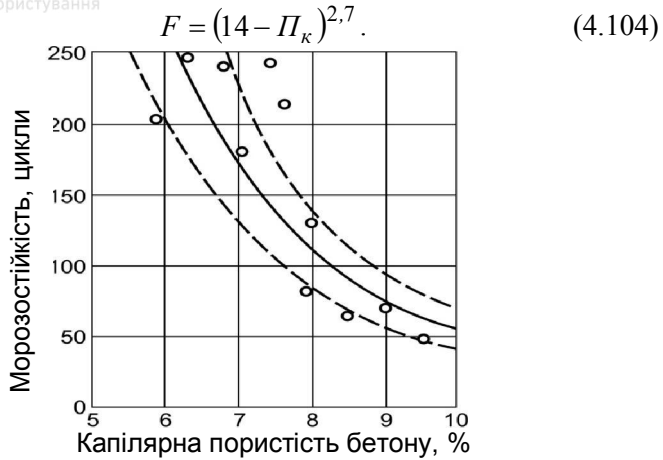
Рис. 4.27. Залежність морозостійкості бетону від капілярної пористості (за Г.І.Горчаковим)
