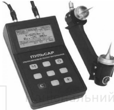
Рис.3.19. Ультразвуковий прилад для контролю міцності Пульсар-1.0
