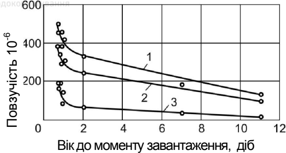
Рис. 4.22. Вплив віку в момент завантаження на повзучість бетону на глиноземистому цементі; час під навантаженням: 1 – 100 діб; 2 – 28 діб; 3 – 1 доба
