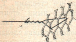
Рис. 86. Прикрепление к стенкам внутренних проволочных связей.
