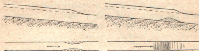
Рис. 295. Подпор, вызванный обмелением дна или сужением русла.
