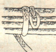
Рис. 92. Обвязка прутяного каната вицей, имеющей петлю.
