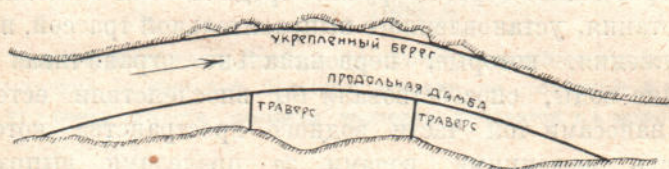
Рис. 46. Выправление русла односторонней продольной дамбой.
