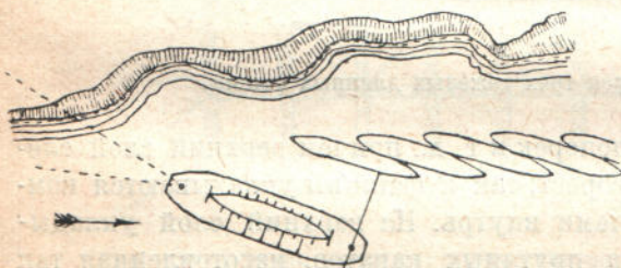
Рис. 100. Укладка тяжелых фашин с судна.
