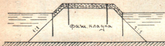
Рис. 170. Укрепление гребня полузапруд на р. Западной Двине.
