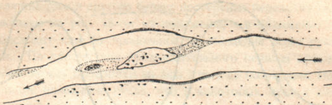
Рис. 21. Образование рукавов при твердых грунтах.
