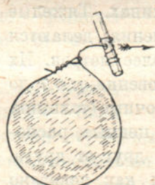
Рис. 97. Затяжка тяжелой фашины проволокой.
