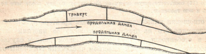
Рис. 45. Выправление русла парными (двухсторонними) дамбами.
