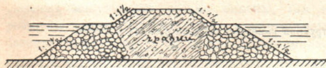
Рис. 174. Разрез головной части полузапруды из каменной наброски с ядром из гравия.
