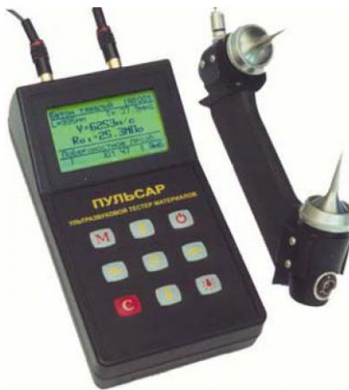
Рис. 8. Ультразвуковий прилад для контролю міцності Пульсар-1.0
