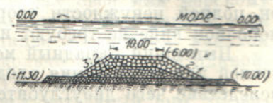
Рис. 18. Профиль Западного мола в Порт-Саïде от км 5 до км 6 (1923—1924).
