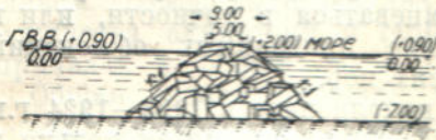
Рис. 13. Профиль Западного мола, в Порт-Саïде на км 2+150 м (1864—1868).
