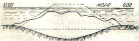
Рис. 17. Профиль удлинения Западного мола в Порт-Саïде (после осадки в 1922).
