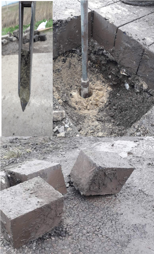
Рис. 4. Фотофіксація з відбору зразків дорожнього одягу та ґрунту основи
