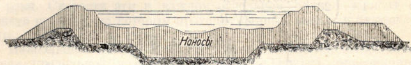
Фиг. 15. Поперечное сечение оросительного канала, занесенного наносами.
