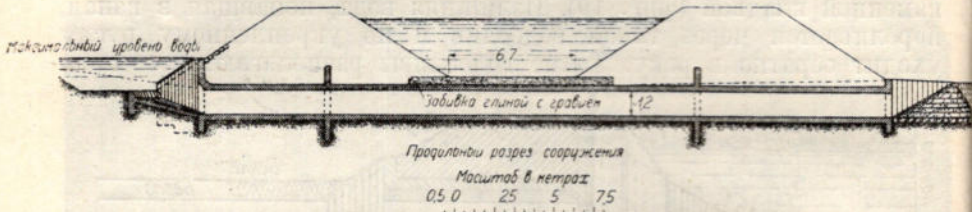
Фиг. 20. Труба под каналом для пропуска ливневых вод.
