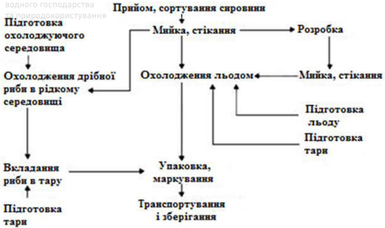
Рис. 11. Технологічна схема охолодження риби в рідкому середовищі
