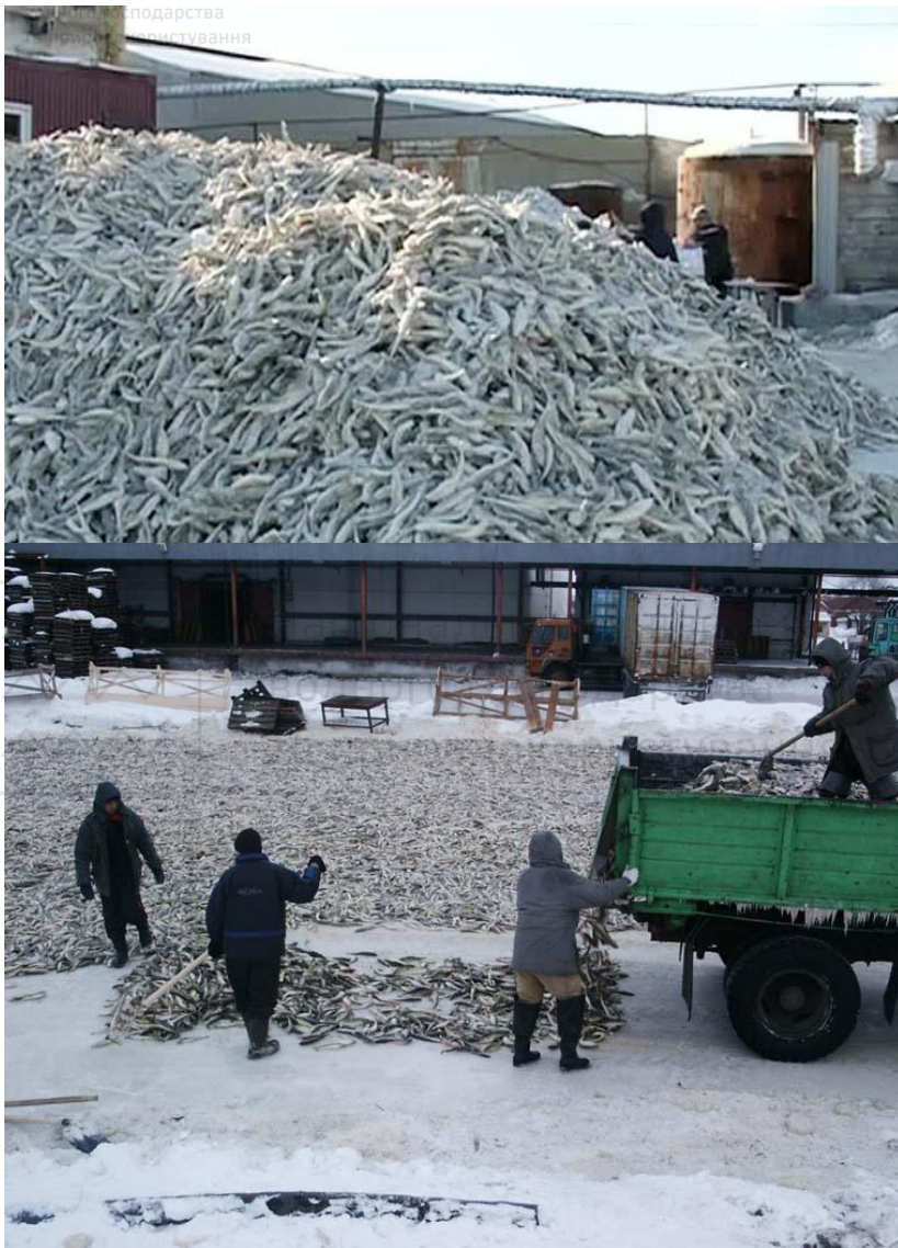
Рис. 15 Природний спосіб заморожування риби Льодосольове заморожування. При добуванні до льоду 14% кухонної солі отримують температуру -9^{\circ}\text{C} , 16 % — до -10^{\circ}\text{C} , 18 % — до -12^{\circ}\text{C} , 24% — до -17^{\circ}\text{C} , 30 % — до —
