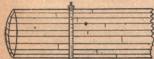
Мал. 38. Водогінні труби з дерева
