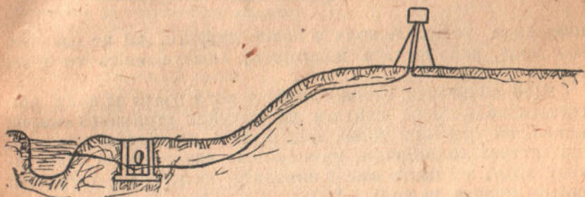
Мал. 43. Загальний вигляд подавання води в башту за допомогою тарана
