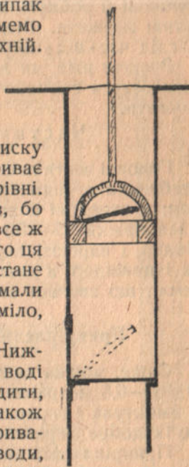
Мал. 30. Толоковий смок (схема дії)
