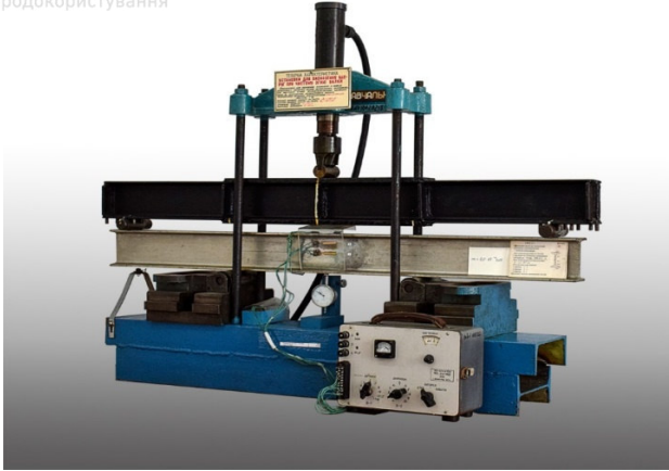
Рис. 8.3. Діюча установка для дослідження напруженого стану балки при чистому згині
