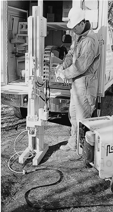
Рис. 1.2. Система внесення наночастинок GeoProbe® Systems, Inc., Salina, Kansas
