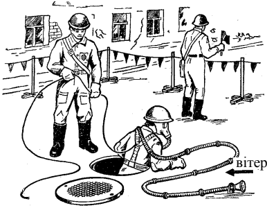
Рис. 3. 14. Спуск у загазований колодязь
