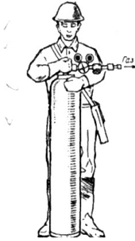
Рис 4.7. Контроль справності редуктора і манометра
