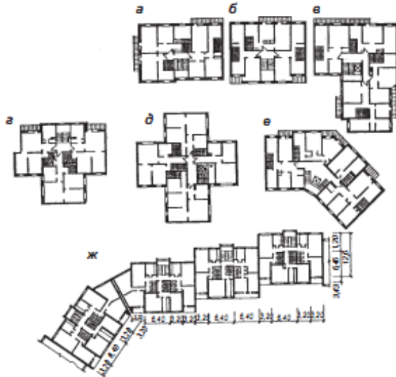
Рис. 2. Схеми типових блок-секцій: а - торцева, б - рядова, в - кутова, г - трилисник, д - хрестовина, е - поворотна, ж - компонування будинку з блок-секцій
