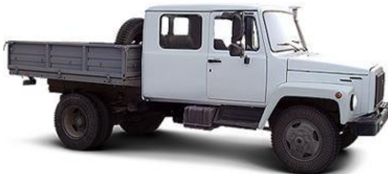
Рис. 1.5. Дворядна кабіна на стандартній базі ГАЗ-3307 (Spectekhnika)
