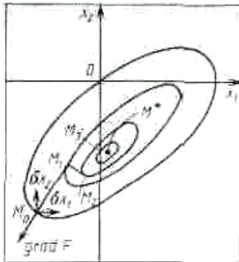
Рис. 2.1. Графічний пошук мінімуму функції методом градієнта
