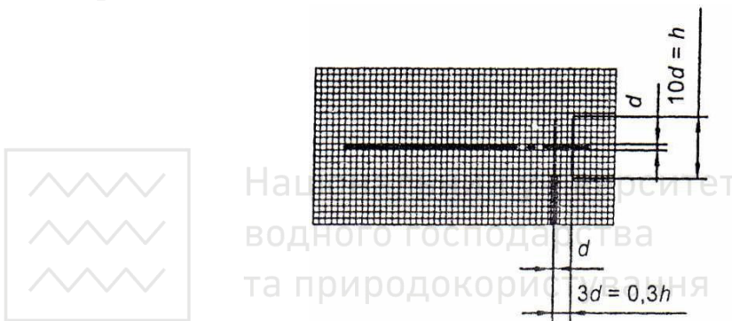
Рис. 2.54. Умовна графічна позначка симетрії
