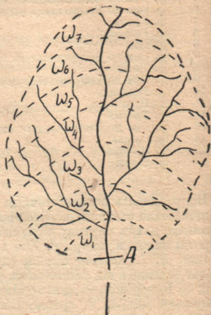
Рис. 107-а. Схема для з'ясування ролі добігання.
