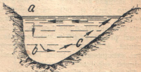
Рис. 56. Схема циркуляції води на плесах.]
