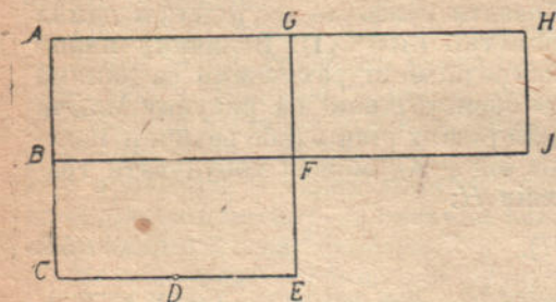
Рис. 55. Схема для порівняння пересічної глибини та гідравлічного радіуса.
