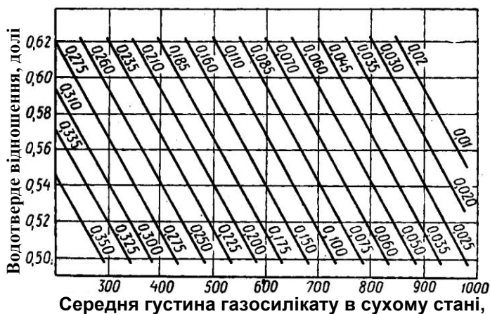
Рис. 5.1. Графік залежності водотвердого відношення та витрати алюмінієвої пудри від середньої густини газосилікату: похилі лінії – витрата алюмінієвої пудри, % від маси твердих матеріалів: верхнє значення – для піску з питомою поверхнею 3500 см 2 /г; нижнє – 2500 см 2 /г.
