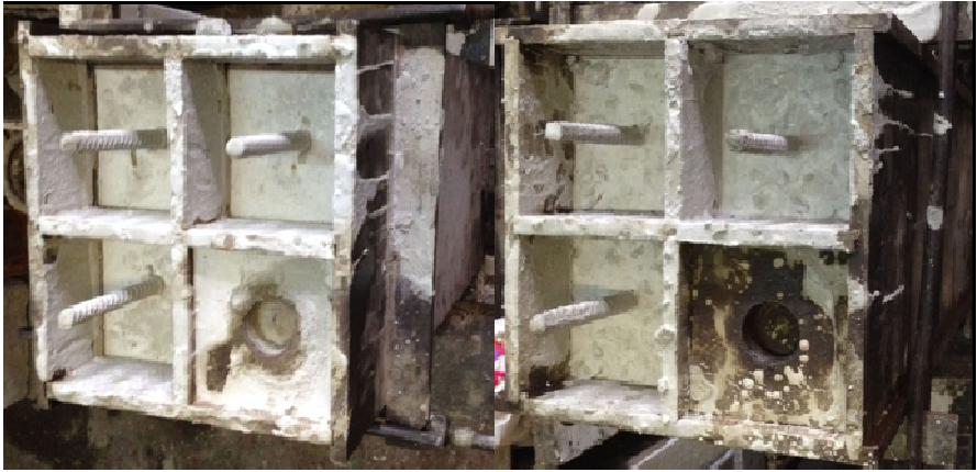
Рисунок 4.4 – До виготовлення довгих призмових зразків (500...600мм)
