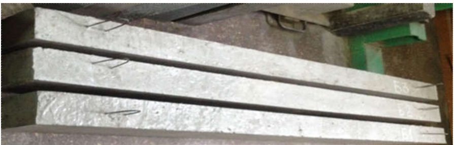
Рисунок 4.3 – До виготовлення залізобетонних балок: а) металеві форми з арматурними каркасами; б) загальний вигляд розпалублених балок
