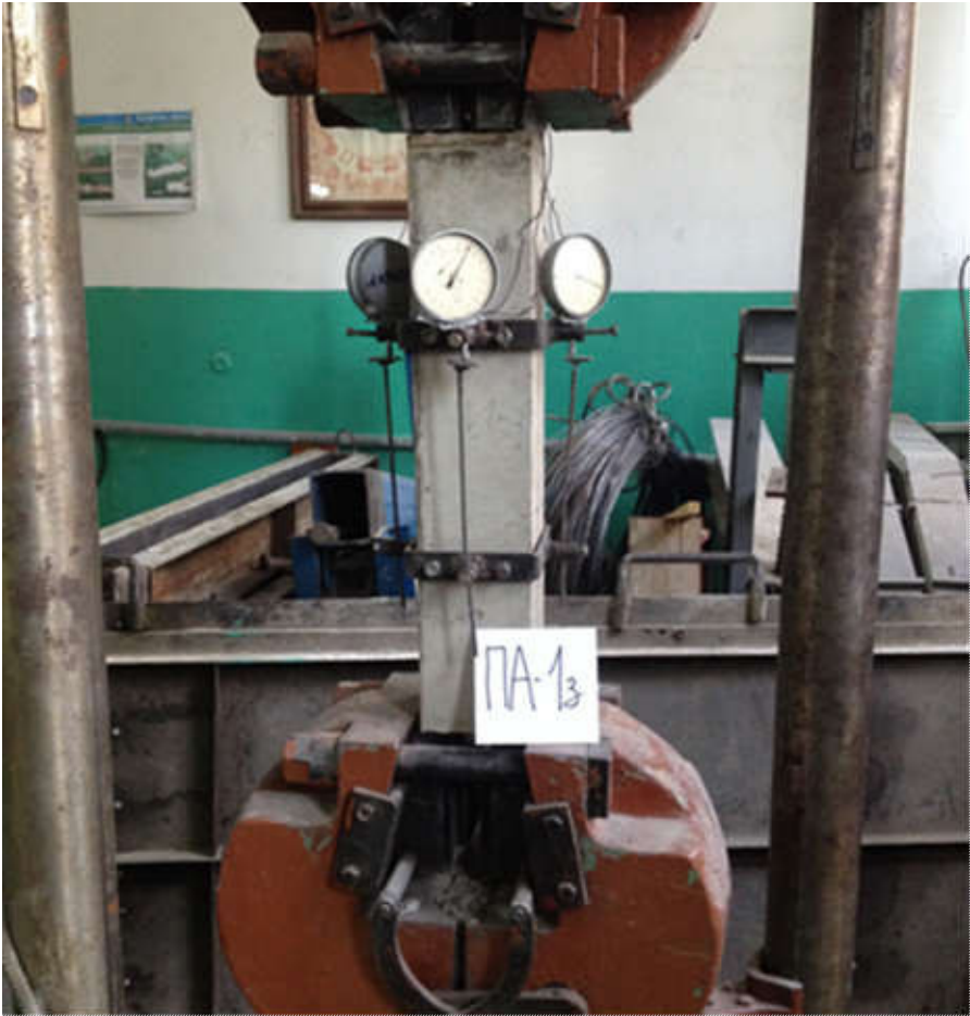
Рисунок 4.5 – Вигляд призматичного зразка з вимірювальними приладами в розривній машині
