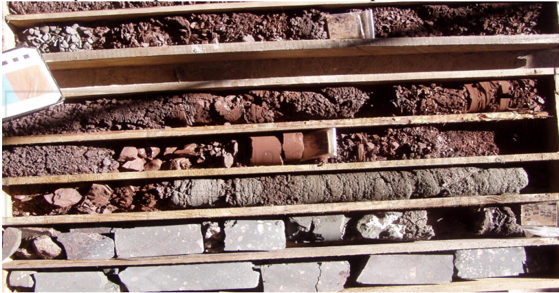
Рис. 4.25. Межа мигдалекам'яних базальтів лучичівської світи (сірий колір) з горизонтом вулканоміктових брекчій в основі зорянських верств (оливковий колір) в св. 8282, на гл. 184,0 м. Вулканоміктові пісковики і бентонітові глини – червоний колір Діаметр керну – 70 мм
