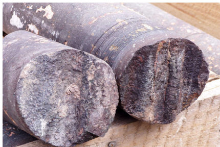
Рис. 4.3. Характер поверхні базальтових потоків заболотівської світи: а – канатна відокремленість в керні св. 8278 (гл. 237,6 м)
