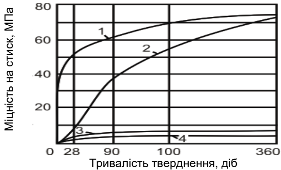
Рис. 8.13. Кінетика зростання міцності мономінерального каменю в часі: 1 – C_3S ; 2 – \beta - C_2S ; 3 – C_3A ; 4 – C_2(A, F)
