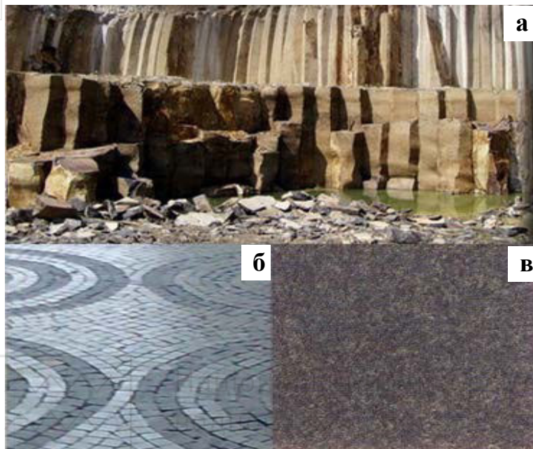
Рис. 5.9. Загальний вид базальтового кар'єру (а), бруківки з базальту (б) і структури полірованої базальтової плити (в)
