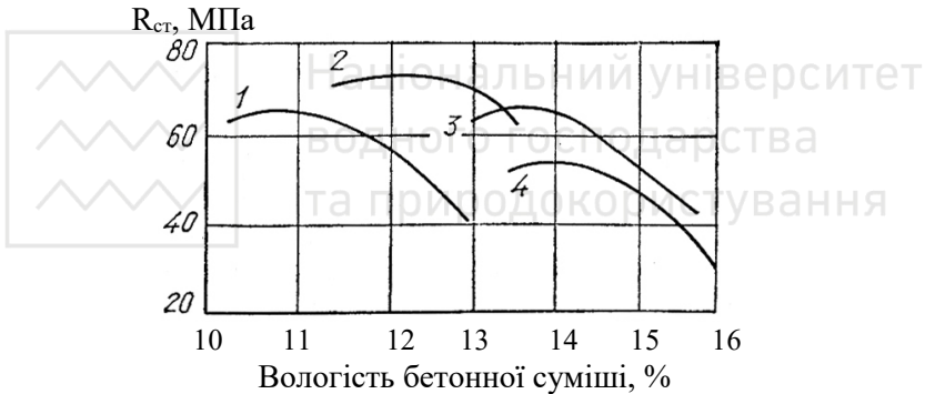
Рис. 12.3. Залежність міцності при стиску шлаколузного бетону від вологості суміші і масової частки глинистих часток у заповнювачі : 1 – 1,2%; 2 – 5,2%; 3 – 6,4%; 4 – 8,8%
