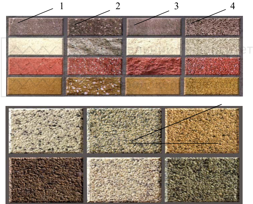
Рис. 11.13. Декоративні бетони різної фактури: 1 – гладка; 2 – колена з крупним заповнювачем; 3 – колена з дрібним заповнювачем; 4 – зерниста; 5 – мозаїчні фактури, отримані способом розмивання шару в'язучого
