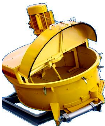
Рис. 14. Планетарний змішувач з об'ємом готового замісу 500 л
