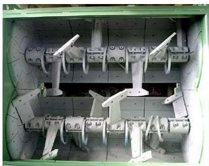
Рис. 15. Двовальний примусовий бетонозмішувач серії СВ
