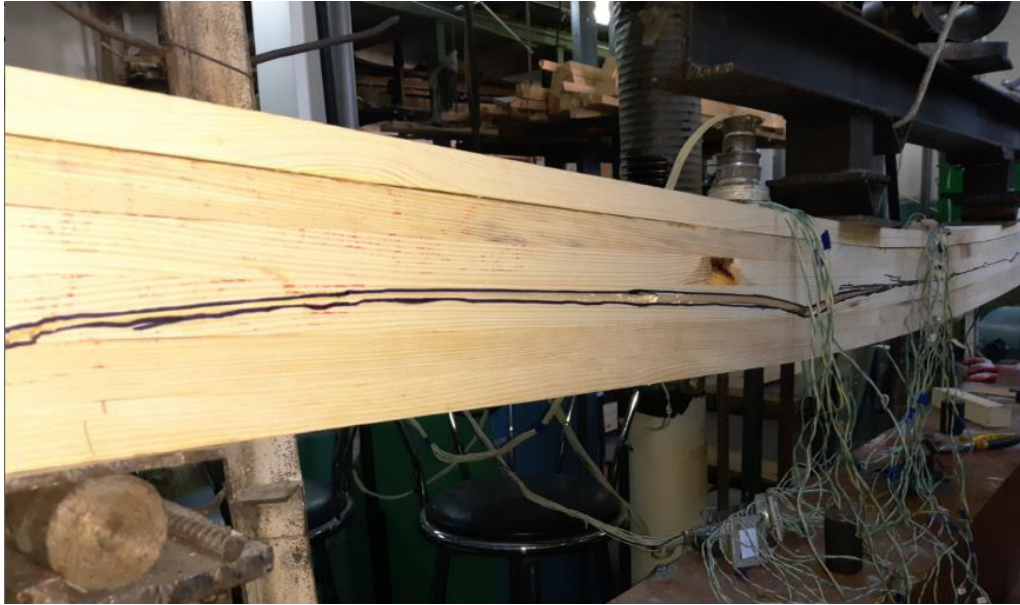
Рис. 4.29. Характер руйнування балки БКА-12В
