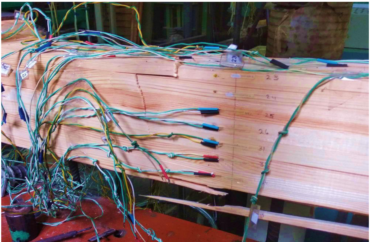
Рис. 4.2. Характер руйнування зразка БК-А в зоні чистого згину
