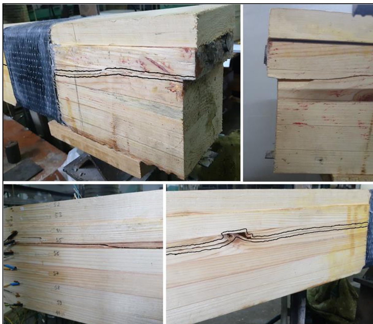
Рис. 4.25. Характер руйнування балки БКА-16Б
