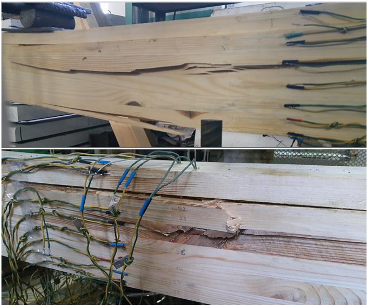
Рис. 4.20. Характер руйнування балки БКА-16А в зоні чистого згину по обох бічних гранях
