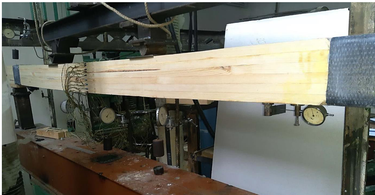
Рис. 4.24. Загальний вигляд балки БКА-16Б під навантаженням
