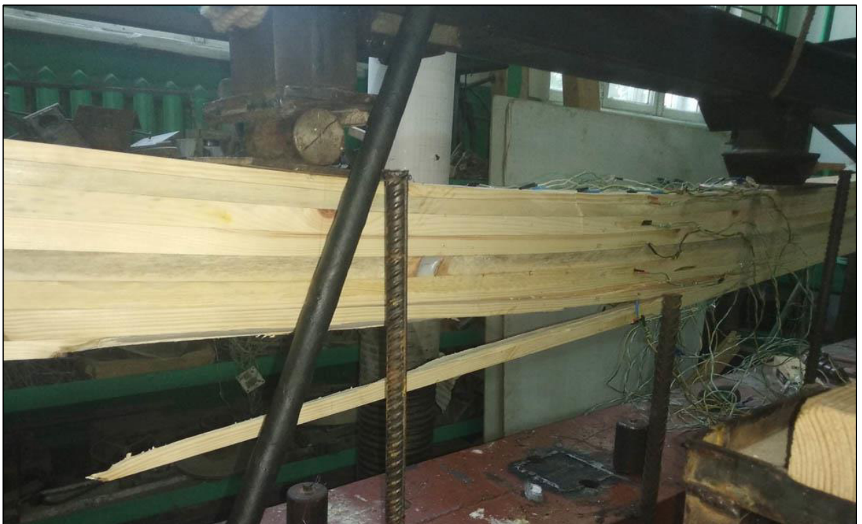
Рис. 4.4. Характер руйнування зразка БК-Б
