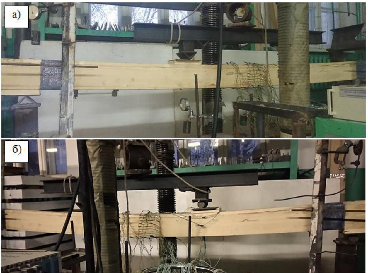
Рис. 4.14. Загальний вигляд балки БКА-12Б під навантаженням:
