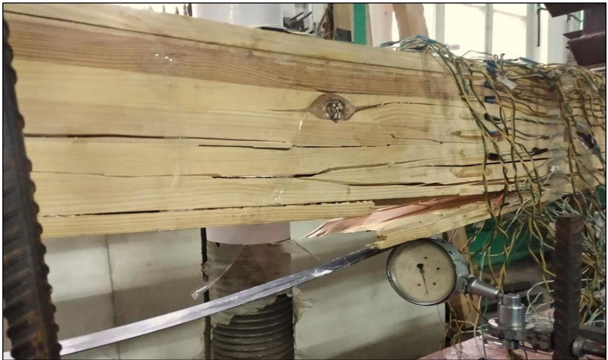
Рис. 4.10. Характер руйнування балки БКА-12А в зоні чистого згину
