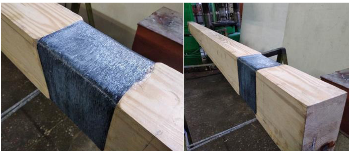
Рис. 2.7. Приклеювання першого шару полотна SikaWrap-230 C
