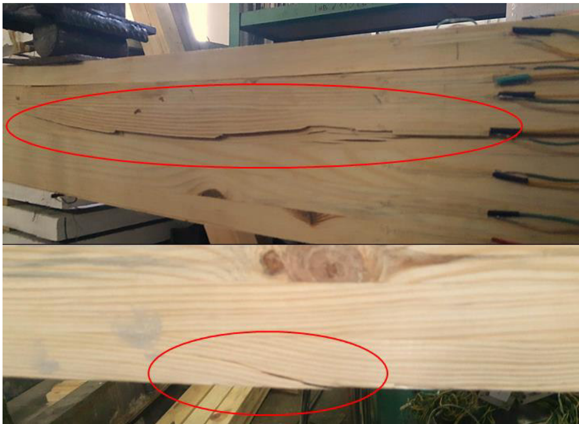
Рис. 4.19. Пошкодження в балці БКА-16А за моменту 0,9M_{max}
