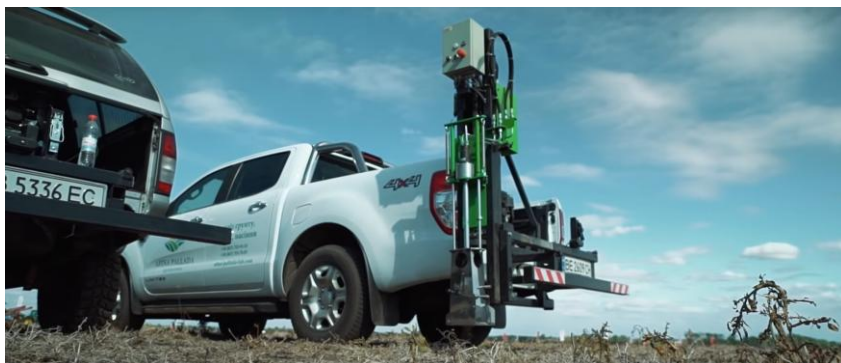
Рис. 23. Мобільний пробовідбірник на автомобільному шасі, SkokAgro, Україна
