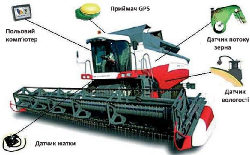
Рис. 31. Розташування обладнання для картування врожайності на зернозбиральному комбайні
