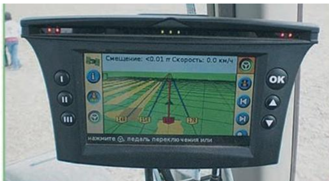
Рис. 22. Інтерфейс навігаційного приладу EZ-Guide 500 Lightbar у роботі
