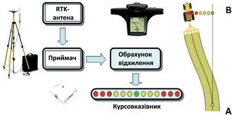
Рис. 4. Принцип функціонування курсовказівника
