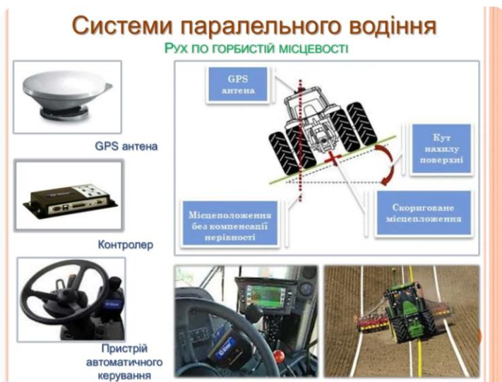
Рис. 5. Типовий склад системи паралельного водіння
