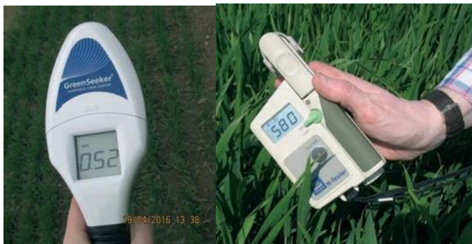
Рис 33. Оптичні датчики для визначення потреби у азотному живленні
